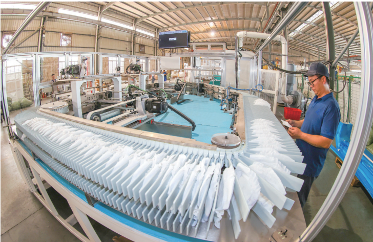
海纳智能新一代高速智能纸尿裤生产设备,一分钟生产纸尿裤800—1000片。
