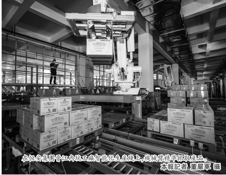
在恆安集團晉江內坑工廠智能化生產線上，機械臂精準抓取產品。
