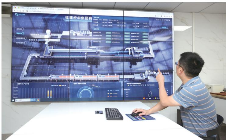
除了热量回收和燃烧效率提升的举措外,今年,宏华集团还引入24小时在线的AI管家系统。“这套系统就是能耗‘CT机’。每台设备都配有智能电表,可实时检测电流大小;同时,300多个参数会同步传给‘数字管家’。”李毅强介绍,这个被称为“数字管家”的能碳协同管理平台将生产数
