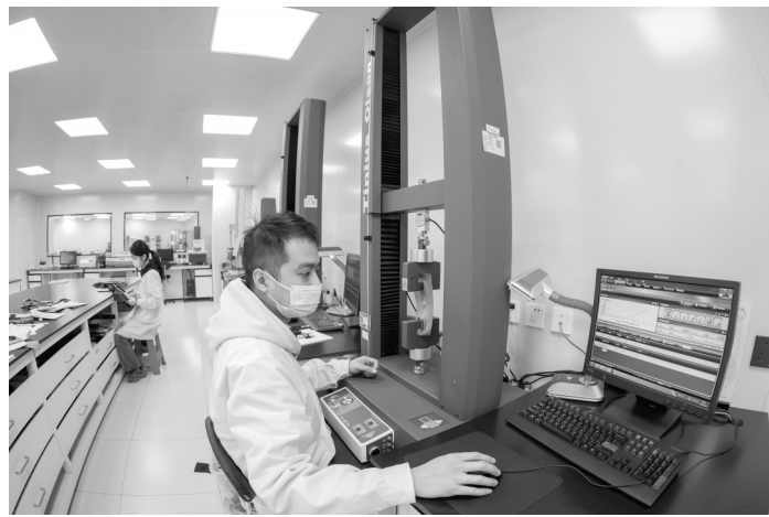
利郎面料研發中心裏，工作人員正在利用設備測試材料的斷裂度。
