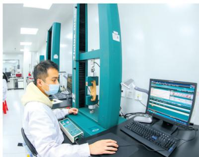
利郎面料研发中心里,工作人员正在利用设备测试材料的断裂度。
