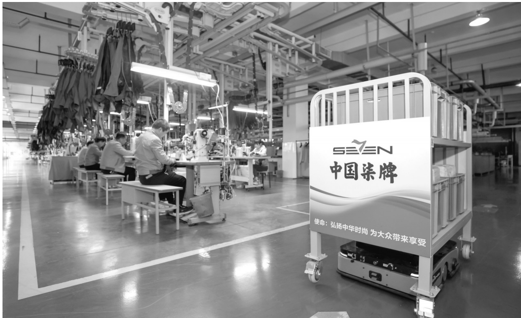
AGV 機器人將面料自動搬移到對應的車間。
