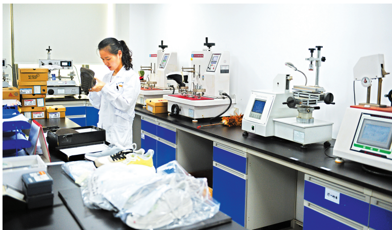
6月18日,中国皮革和制鞋工业研究院(晋江)有限公司科研人员在实验室检测鞋底耐磨性。新华社记者 刘勇贞 摄
