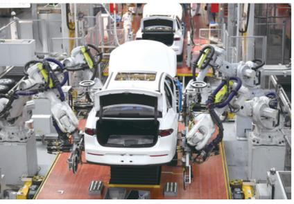
在广州市番禺区的广汽埃安新能源汽车股份有限公司总装生产线，机器人手臂在安装汽车轮胎（2023年2月24日摄）。新华社记者 邓华 摄
