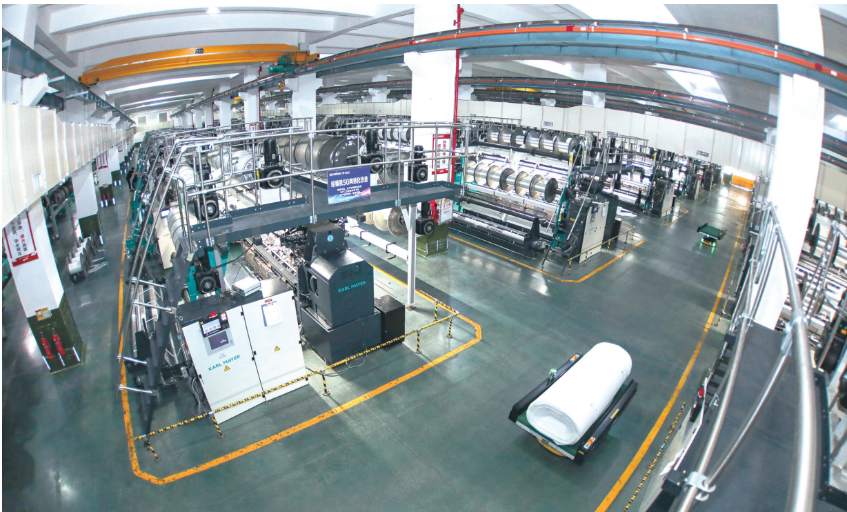
福建晋江华宇铮瓷集团智能化车间，AGV物流机器人在搬运经编成品。
