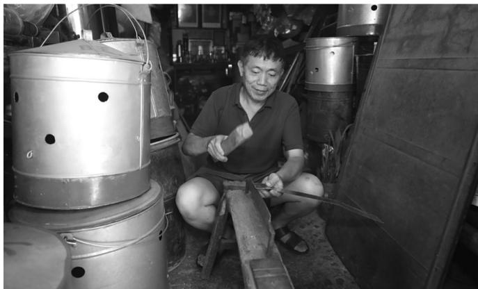
子、锤子、木棒和剪刀。高铭德介绍,白铁延展性好,加工白铁皮是通过剪刀裁剪,然后通过铁锤、木棒等敲打铁皮,使之变成各种形状的成品。
