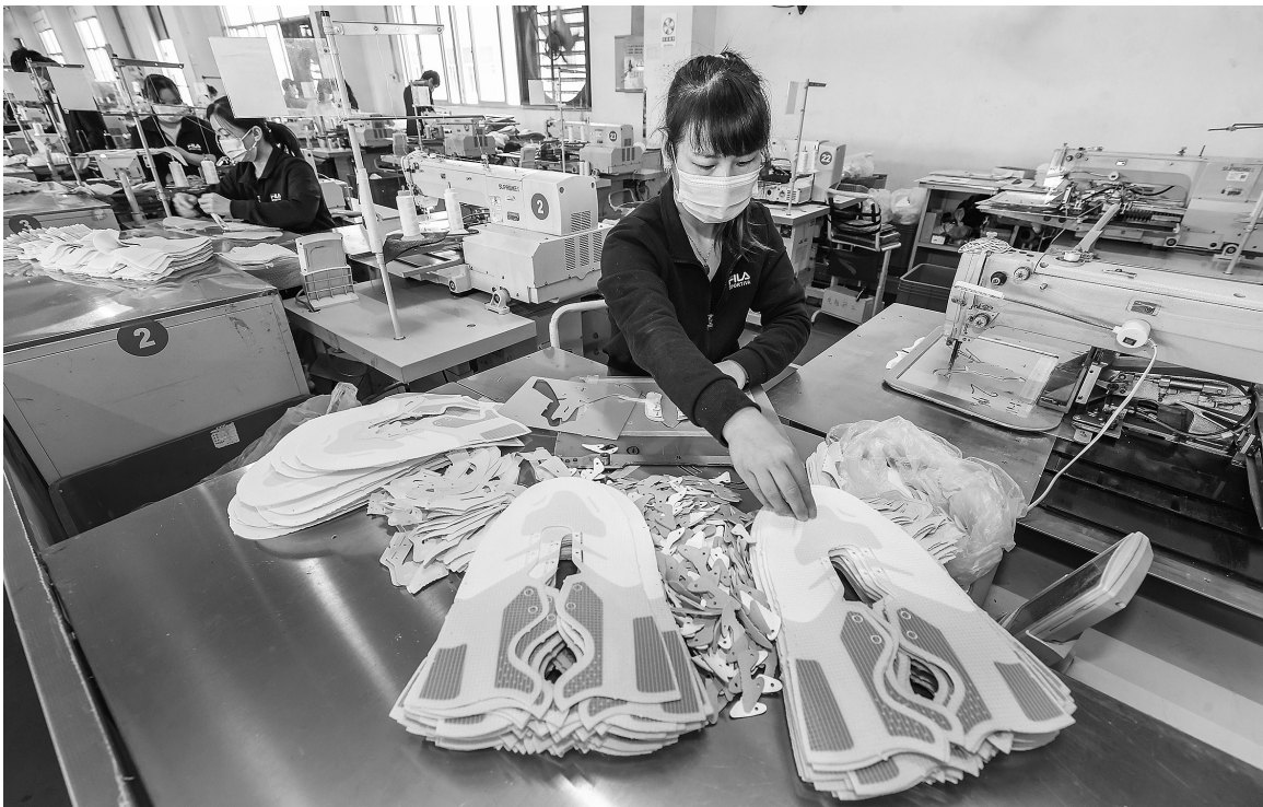
安踏運動鞋生產車間，升級後的電腦針車用工更少效率更高。
