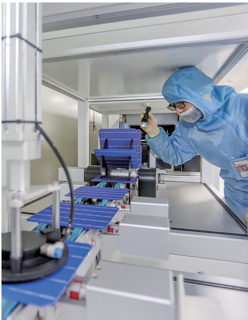
金石能源HDT高效太阳能电池片生产线。
